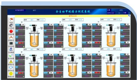
15"宽屏彩色液晶触摸屏，进口PLC可编程控制人机界面友好，一台控制器可同时检测并控制多通道甲烷潜力测试系统相应参数，用户可以根据工艺要求，任意选择通道数量。一机多用，满足不同通道数量需求
